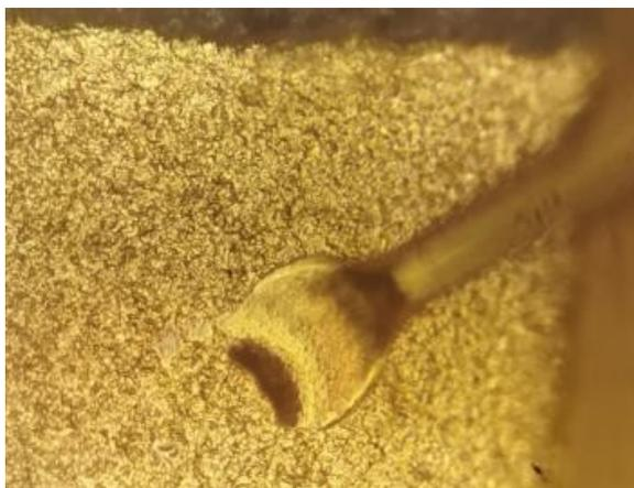
Рис. 8. Вид клинового соединения золотой проволоки диаметром 25 мкм на установке ЭМ-4550.
