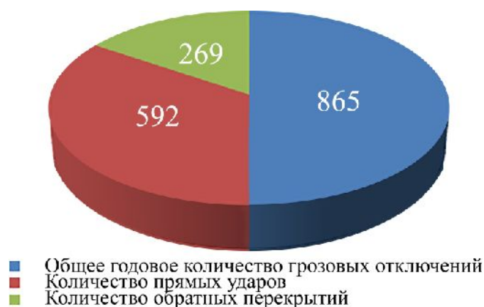
Рис. 2. Диаграмма годового общего количества отключений электроэнергии из-за молний (2018 г., Государственная сетевая корпорация, Китай).
