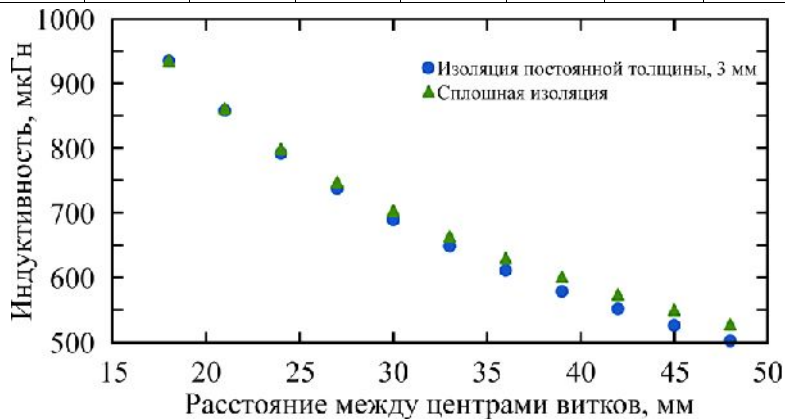
Рис. 10. Зависимость индуктивности FDD от шага катушки.
