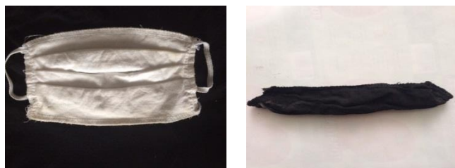
Рис. 7. Слева – маска б/у из хлопчатобумажной ткани; справа – та же маска, подвергнутая пиролизу при t \sim 900 °С в цилиндрическом аппликаторе.
