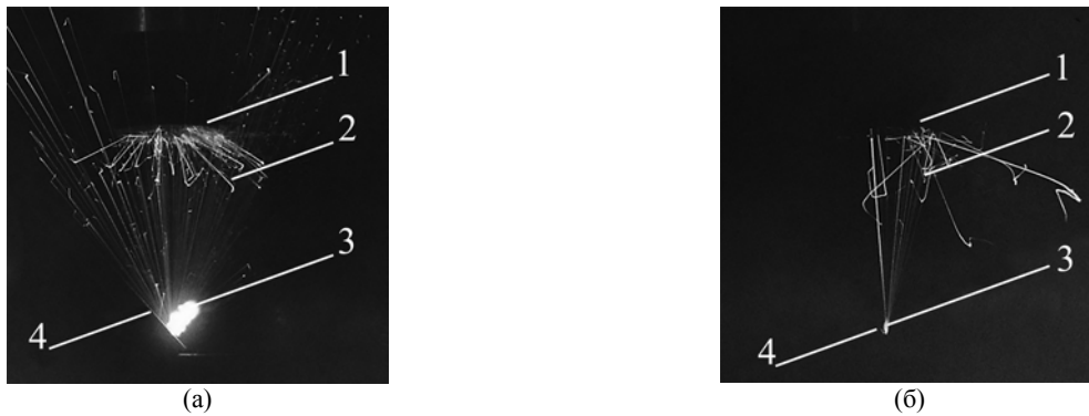
Рис. 6. Образование плазменного облака при многоимпульсной лазерной обработке ( E_p = 1,0 Дж, \tau_p = 200 мкс, d_p = 100 мкм, \alpha = 40^\circ ) образцов из SiC первым (а) и третьим (б) импульсами, где 1 – фокусирующий объектив; 2 – «брызги» материала; 3 – плазменное облако; 4 – образец.
