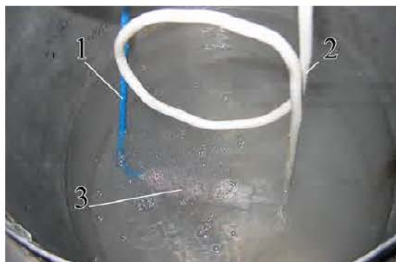
Рис. 5. Определение температуры образца в процессе МДО: 1 – термопровод, передающий температуру на датчик; 2 – подвеска; 3 – образец.
