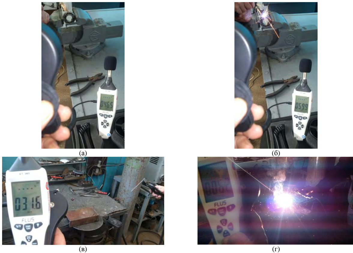
Рис. 7. Освещенность в помещении до (а) и при (б) ЭИЛ стали 12Х18Н10Т электродом из твердого сплава Т15К6 и до (в) и при наплавке на сталь 12Х18Н10Т износостойкого покрытия электродом марки ОК61.30 \varnothing 2,5 мм.
