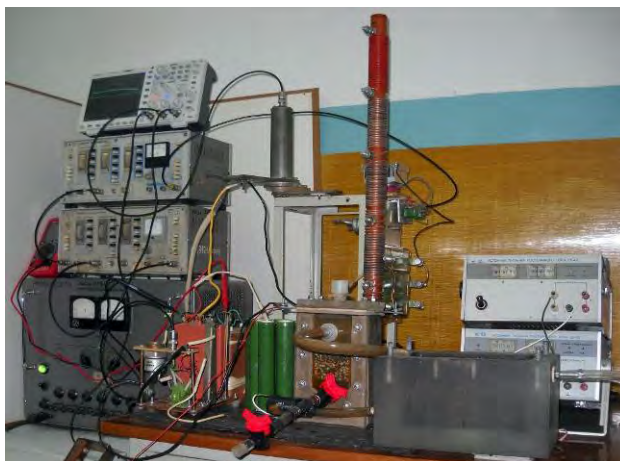
Рис. 1. Лабораторная установка по очистке гальваностокков.
