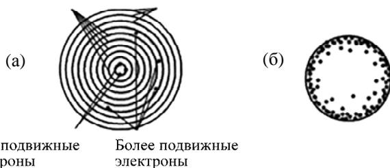
**Рис. 4.** Поверхностный эффект (скин-эффект) как фактор увеличения активного сопротивления в цепи переменного тока. Ток вытесняется магнитным полем на поверхность проводника (а), поэтому у поверхности проводника плотность тока больше, чем внутри проводника (б).
