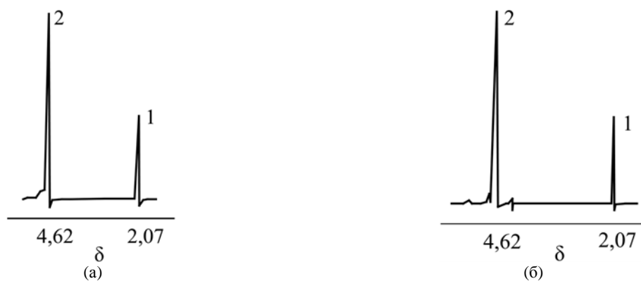
Рис. 3. Спектры ^1\text{H} ядерно-магнитного резонанса. Дистиллированная вода до (а) и после обработки (б) низкотемпературной плазмой. Сигналы синглета метильной группы ацетона (1) и протонов воды (2). \delta – химический сдвиг (м.д.).
