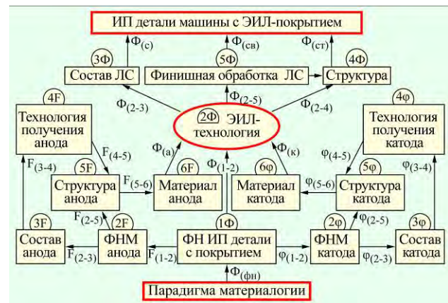
Рис. 7. Развернутая методологическая схема получения ЭИЛ-покрытий на ИП деталей машин.
