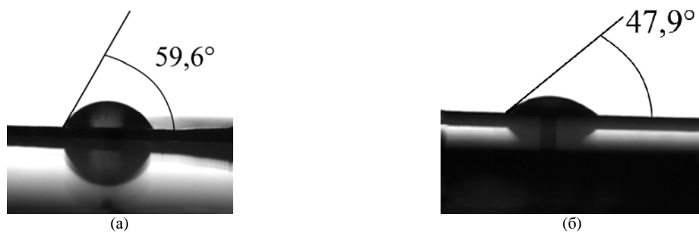
Рис. 3. Изображения капли дистиллированной воды с соответствующими значениями краевого угла смачивания ПСА мембраны: (а) исходной; (б) плазмообработанной.
