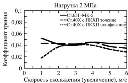
Рис. 3. Зависимость коэффициента трения от скорости, снятая при увеличении скорости скольжения.
