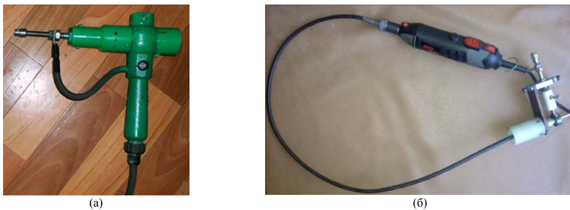
Рис. 4. Вибратор для ЭИЛ электромеханический: (а) – внутреннее; (б) – внешнее расположение электродвигателя.
