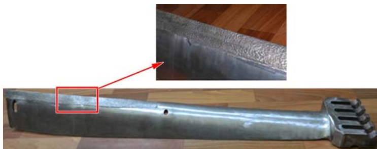
Рис. 5. Внешний вид лопатки паровой турбины с ЭИЛ покрытием на рабочей кромке.
