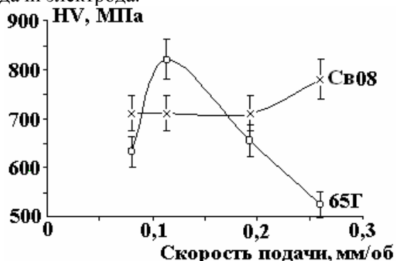
Рис. 10. Зависимость величины микротвердости на расстоянии 15 мкм от границы покрытие-подложка от скорости подачи
