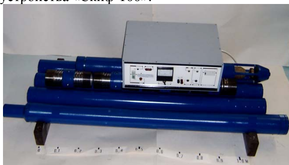
Рис. 6. Источник питания (наземная часть) и блоки погружной части электроразрядного погружного комплекса «Скиф-100М»
