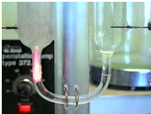
Рис. 2. Внешний вид реактора и разряда
