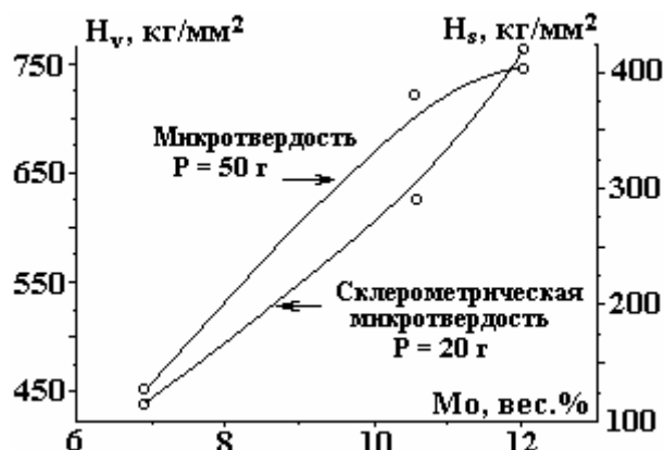
Рис. 7. Влияние содержания молибдена в покрытиях на их квазистатическую и склерометрическую микротвердость
