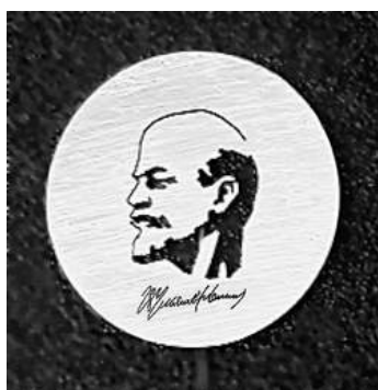
Рис. 4. Образцы значков (а-г) и медали (д), представляющие сквозные сложные профили, вырезанные в заготовках из нержавеющей стали толщиной 1–3 мм
