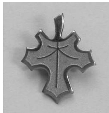
Рис. 4. Образцы значков (а-г) и медали (д), представляющие сквозные сложные профили, вырезанные в заготовках из нержавеющей стали толщиной 1–3 мм
