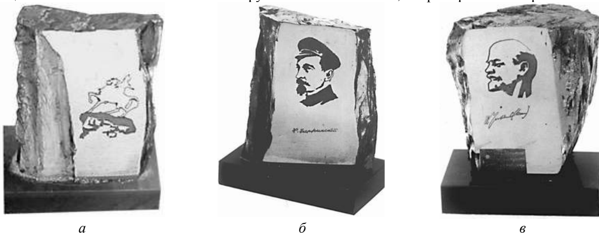
Рис. 6. Сувениры с отпечатками, выполненными комбинированным электроискровым способом на полированных поверхностях кусочков литого магнитного сплава ЮНДК
