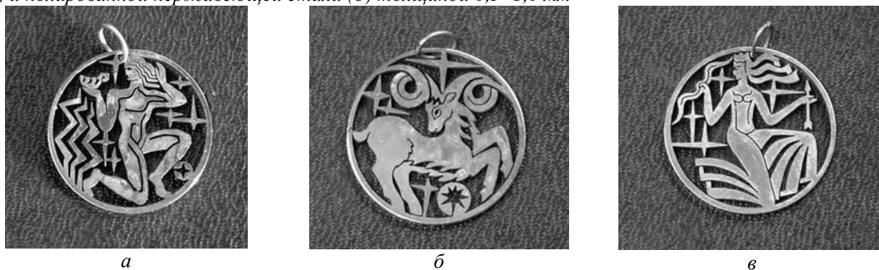
Рис.8. Образцы кулонов, изготовленных электроискровой вырезкой в заготовке толщиной 1 мм
