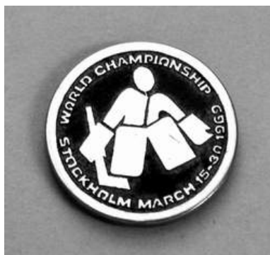
Рис. 4. Образцы значков (а-г) и медали (д), представляющие сквозные сложные профили, вырезанные в заготовках из нержавеющей стали толщиной 1–3 мм
