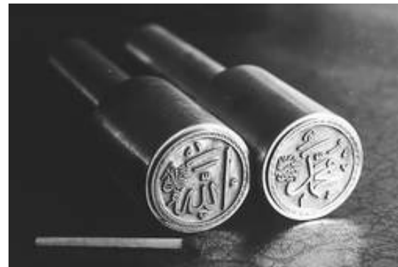
Рис. 11. Матрицы чеканочных штампов (а) и электроды-инструменты для их изготовления (б)
