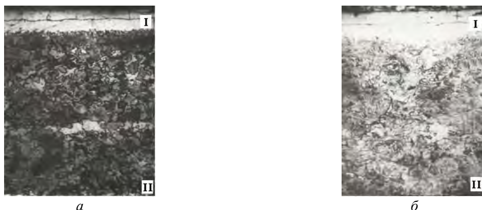
Рис. 3. Структура азотированной стали: а – сталь 45 (x320): I – нитридный слой ( \epsilon -фаза Fe_3N и \gamma' -фаза Fe_4N ); II – перлитно-ферритная структура; б – сталь 40X (x500), I – нитридный слой, II – обогащенный нитридами мартенсит
