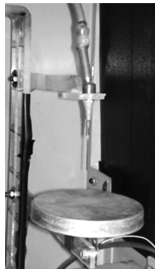
Рис. 1. Экспериментальная установка. Система электродов игла–плоскость. Радиус закругления оконечности иглы 0,21 мм, межэлектродное расстояние 24 мм.
