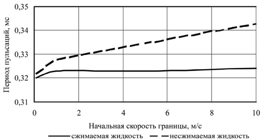
Рис. 3. Зависимость изменения периода пульсации газовой полости от начального возмущения для случаев сжимаемой и несжимаемой жидкостей.
