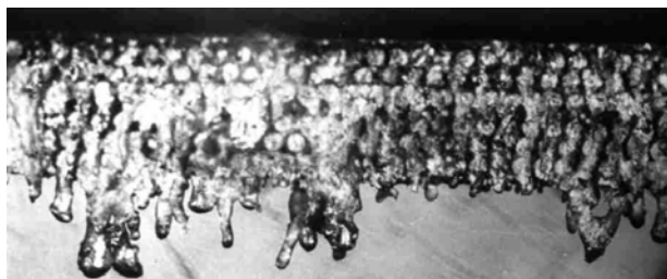
Рис. 2. Вид стенки реза КМ Al-B после лазерного разрезания в газолазерном режиме (толщина заготовки 1,15 мм, \lambda = 1,06 мкм, P = 300 Вт, p = 0,3 МПа, V = 1,7 мм/с).
