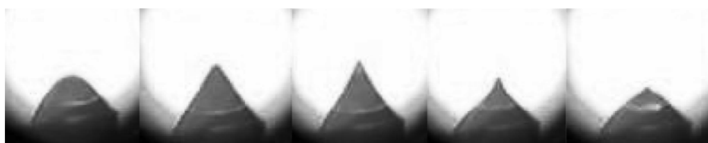
Рис. 11. Пульсации микроконуса касторового масла; кадры сняты с интервалом \Delta t = 0,02 с, U = 10 кВ.
