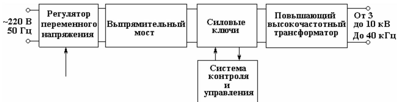
Рис. 2. Структурная схема генератора
