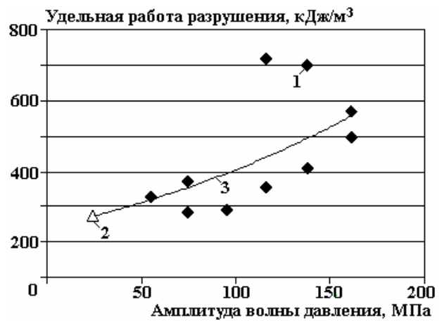
Рис. 6. Зависимость удельной работы разрушения угля от амплитуды волны давления. 1 – разрушение; 2 – без разрушения; 3 – аппроксимация
