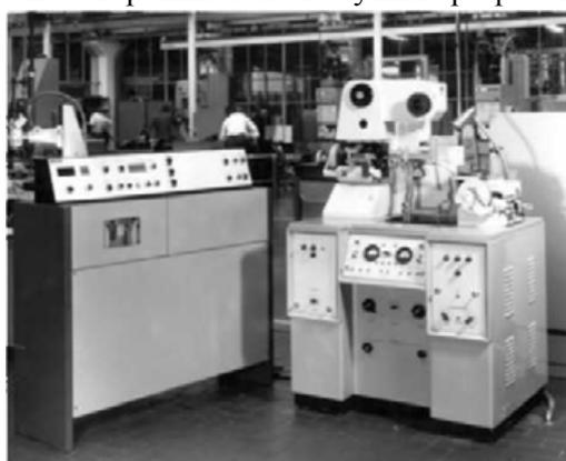
Рис. 21. Электроискровые координатные установки А207.23 (вверху) и А207.27 со встроенным титратронным генератором импульсов (внизу) с ЧПУ Olivetti на фирме
