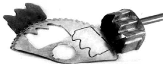
Рис. 7. Контурное вырезание элемента пилы трепанацией
