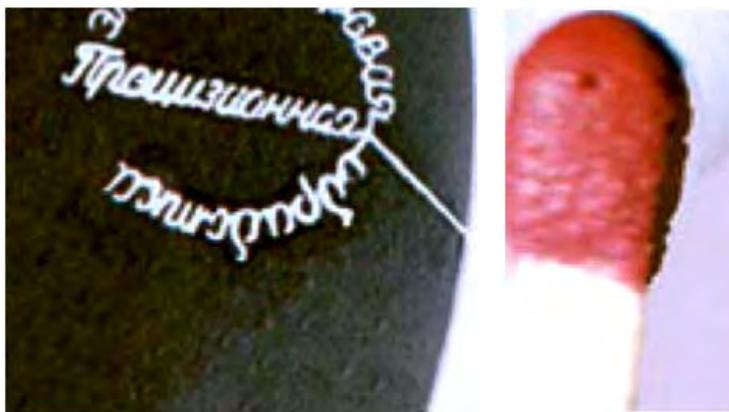
*Надпись «Прецизионная электроискровая обработка» вырезана в пластине ВК-6 толщиной 6 мм проволокой ВА-3 Ø 0,04 мм. Кадр из фильма 1961 г.*
