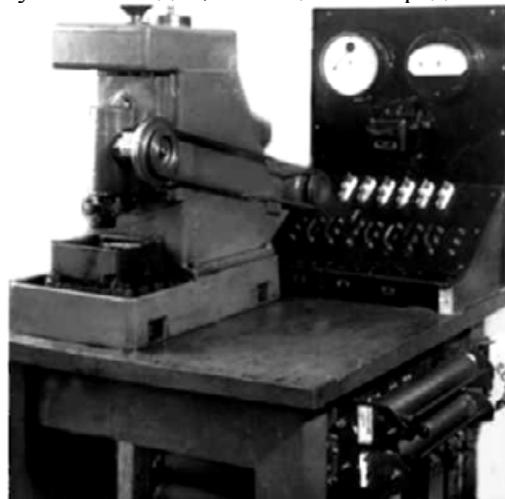
Рис. 5. Электроискровой станок ЭИС-КМП. 1944 г.
