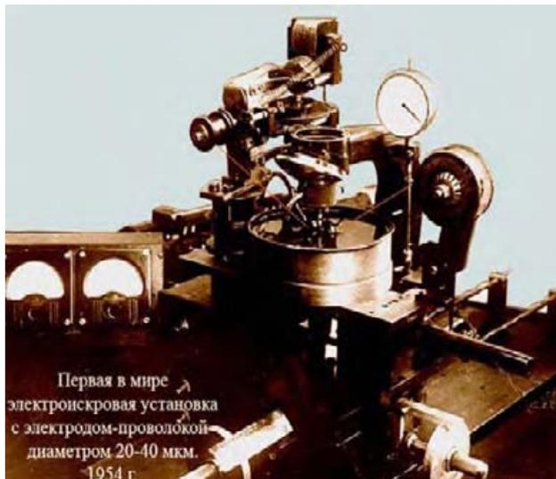
Рис. 22. Первая в мире электроискровая установка с электродом-проволокой  $\varnothing$  20–40 мкм. НИИ-160, г. Фрязино, Московская область. 1954 г.
