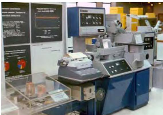
*Рис. 17. Электроискровая координатная установка на базе А207.23 с тиратронным генератором импульсов и СЧПУ на выставке электронной техники в Москве*
