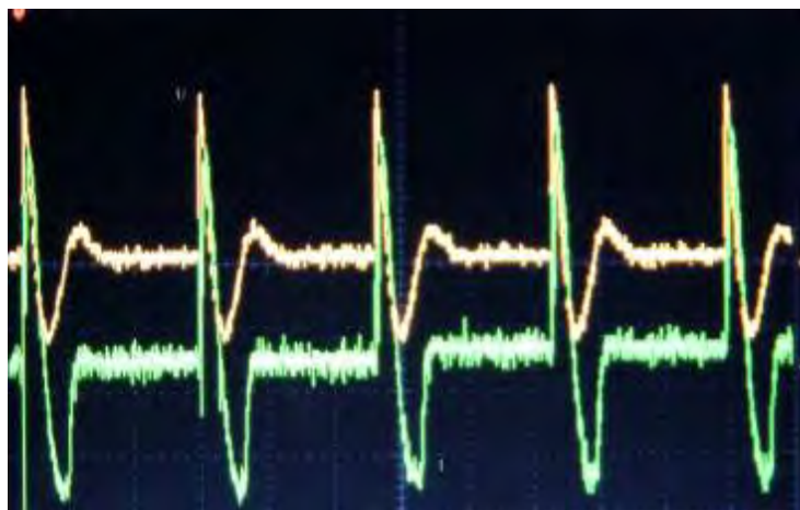
Рис. 2. Осциллограмма разрядного тока и напряжения
