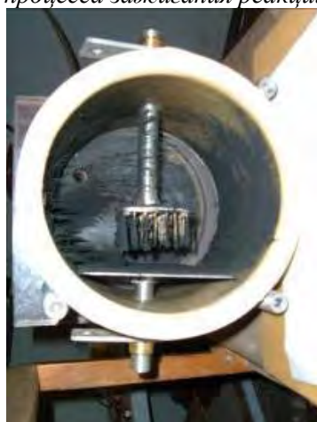
Рис. 4. Сажа из наночуглерода на многоострийной электродной системе после 5 мин обработки
