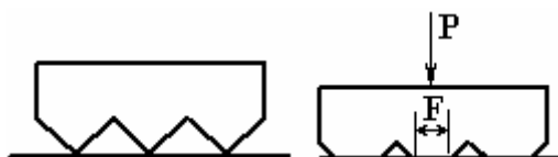
Рис. 1. Схема образования физического контакта при действии сжимающего усилия на сварной образце
