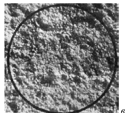
Рис.23 Установка для электроискрового шлифования – приработки мукомольных валков ( а ), вид ( б ) и микрофотография ( в ) их поверхности. R_a = 20 - 25 мкм (1960 г.)
