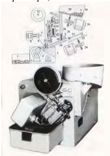
Рис.31 Автомат для электроискровой обработки отверстий \varnothing 0,15 мм
