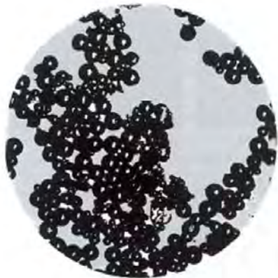
Рис.2 Материал электродов, измельченный электрическими разрядами
