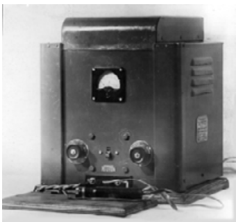
Рис.25 Электроискровая установка легирования металлических поверхностей Харьковского тракторного завода
