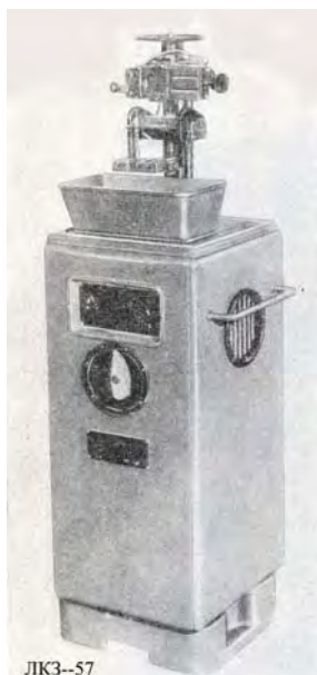
Рис.32 Установка ЛК3-57 для изготовления мелких штампов, профильных фильер и волок
